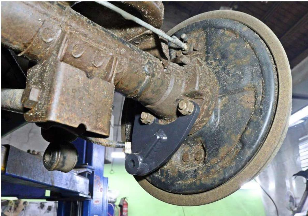
Наглядная установка на автомобиле кронштейнов задних амортизаторов Нива до 2009 г.в.
